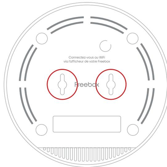
La distance entre les deux vis doit être de 45 mm. Pour une fixation optimale, utilisez des vis de diamètre 3 mm à tête fraisée et laissez une hauteur de 5 mm dépasser du support.
